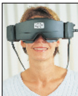
La máscara Combi facilita las pruebas de campo visual abierto y las de oclusión.
